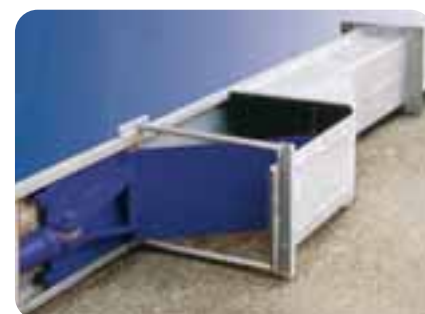
Druckentmistung mit horizontalem Druckkanal mit Anschluss an das PVC Rohr
